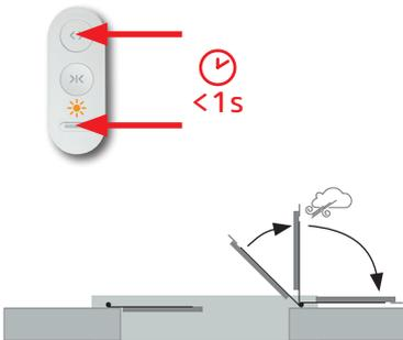
ouverture du battant **avec battue** par paliers successifs en fonction des rafales de vent qui stoppent la motorisation.
