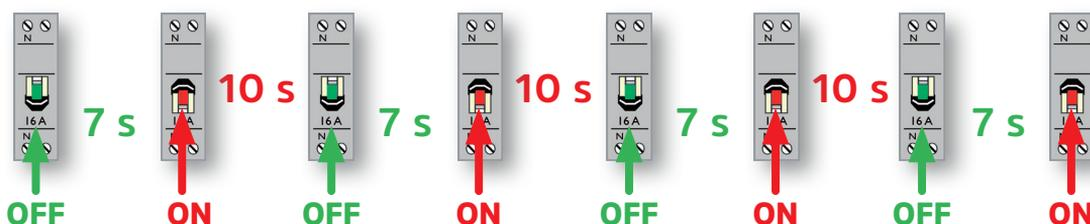
Tous les volets de votre installation vont se fermer (lames en position fermée pour tablier à lames orientables). Le volet en panne reste fermé. Pour les autres il suffit d'utiliser leur télécommande respective, pour retrouver leur fonctionnement individuel habituel.
