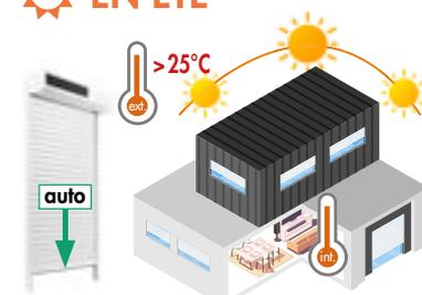
Le volet se baisse en position protection thermique en cas de fort ensoleillement et de fortes températures intérieure ou extérieure.
