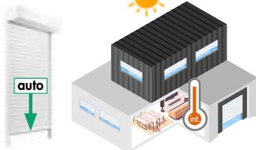
Le volet se baisse en position protection thermique en cas de forte température intérieure.
