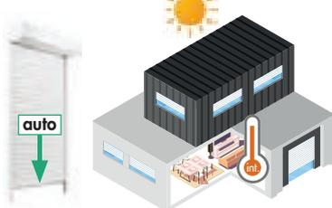
Le volet se baisse en position protection thermique en cas de forte température intérieure.
