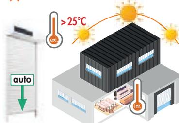
Le volet se baisse en position protection thermique en cas de fort ensoleillement et de fortes températures intérieure ou extérieure.
